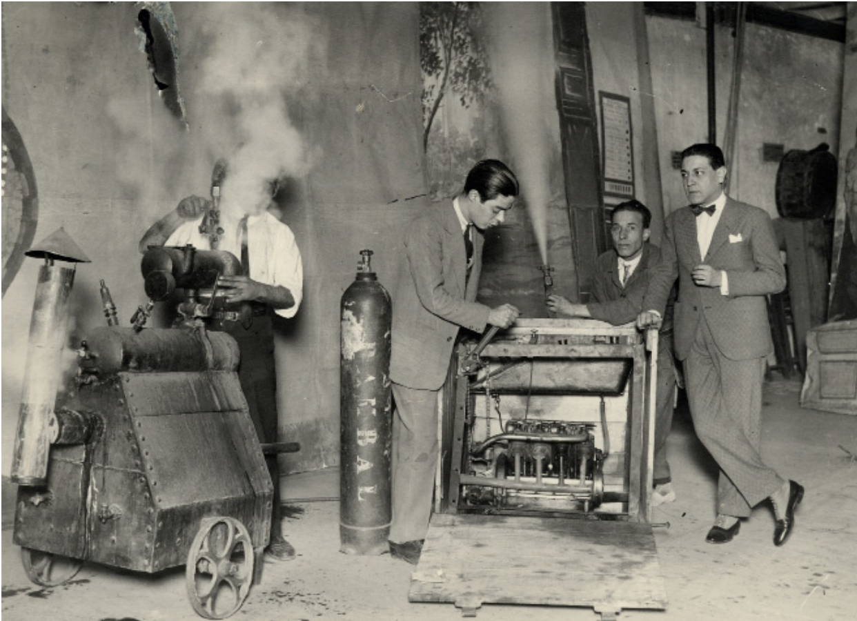
Fig. 1: Máquina usada para producir la niebla. Enrique Rambal es el primero por la derecha. Foto cedida por la Fundación Juan March.
